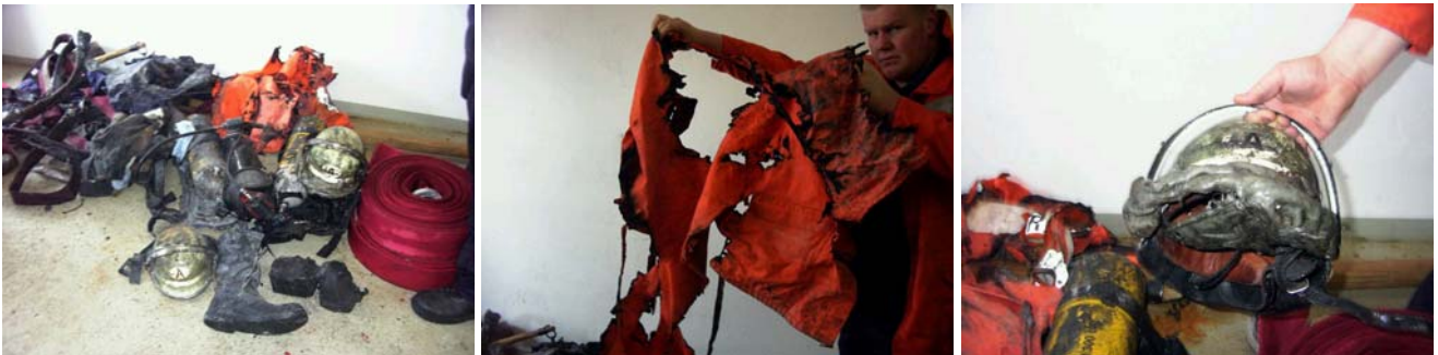
Abb. 19,20, 21: zerstörte Einsatzkleidung nach einem Flashover in Winterfeld (Sachsen-Anhalt).
